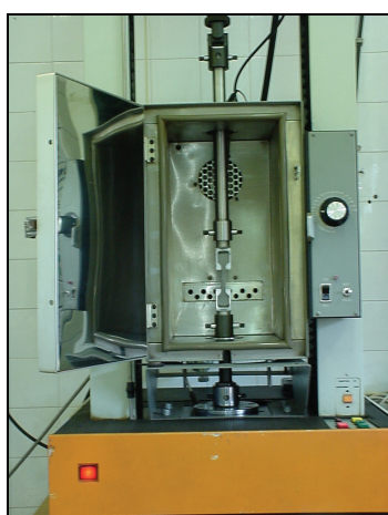
Figure 1. Tensile tester „Instron-1122“.
