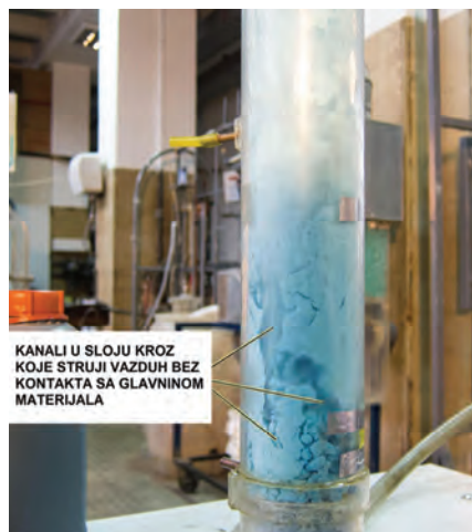
Slika 8. Fluidizacija čestica srednjeg prečnika 0,17 mm. Figure 8. Fluidization of particles of mean diameter 0.17 mm.
