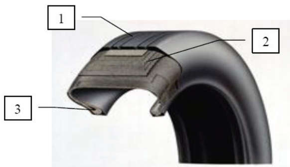
Slika 1. Struktura savremenog pneumatika. 1. gazaći sloj; 2. telo (karkasa); 3. peta (stopa).
