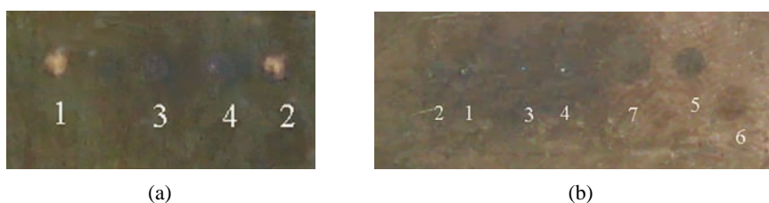
Slika 1. Fotografija zona interakcije laserske svetlosti i površine: a) uzorka bakara i b) uzorka aluminijuma. Figure 1. Interaction zones of laser radiation and surface of: a) copper sample and b) aluminum sample.
