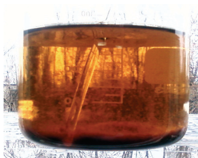
Slika 3. Izgled uzorka otpadne vode sa slike 2 posle 30 min od dodavanja ukupno 80 mg \text{Na}_2\text{FeO}_4 .
