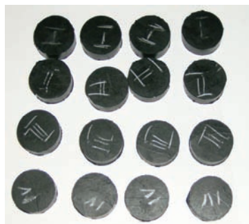
Slika 10. Cilindrične epruvete za ispitivanje po „Yerzley“. Figure 10. Cylindrical specimen for Yerzley testing.
