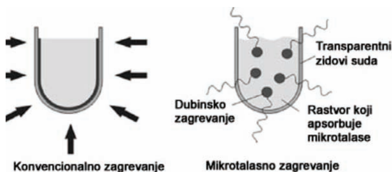
Slika 8. Difuzija toplote pri klasičnom i mikrotalasnom zagrevanju. Tamnijom nijansom su predstavljene oblasti viših temperatura. Figure 8. The transfer of heat in the conventional and microwave heating experiments. Dark regions represent areas with higher temperatures.
