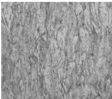
Slika 6. Detalj mikrostrukture sinterovane legure Cu-4 at% Ag nakon hladne plastične deformacije sa stepenom deformacije 60%; 500×
