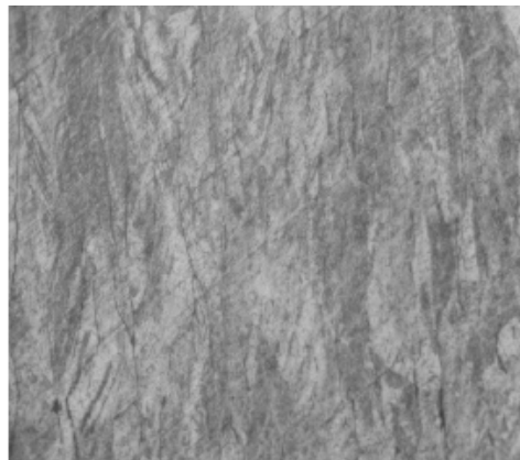
Slika 8. Detalj mikrostrukture sinterovane legure Cu-4 at% Ag nakon hladne plastične deformacije sa stepenom deformacije 60% i žarenja na 260 °C; 500×
