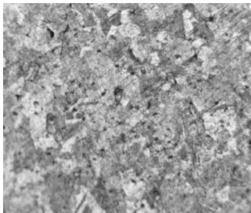
Slika 3. Detalj mikrostrukture sinterovane legure Cu-4 at% Ag; 500×
