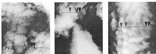
Slika 10. STM slike GCox/Pt elektrode u 0,5 M H 2 SO 4 (100 x 100 nm) (a) oksidovane na E = 2 V i t = 95 s (d = 4,5 nm), (b) oksidovane na E = 2,25 V i t = 35 s (d = 4,4 nm), i (c) oksidovane na E = 2,25 V i t = 95 s (d = 7 nm)
