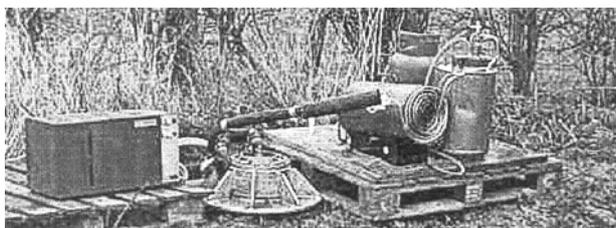
Slika 5: Pilot uređaj za ispitivanje dekontaminacije zemljišta subkritičnom vodom [64] (Express Separation LTD Comp., SAD)
